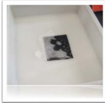
Paso 8: Una vez aplicado el activador esperamos un minuto antes de retirarlo
