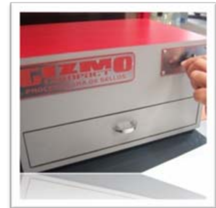
Paso 6: Exponga la película en el procesador Gizmo Compact I durante 7 Min.
